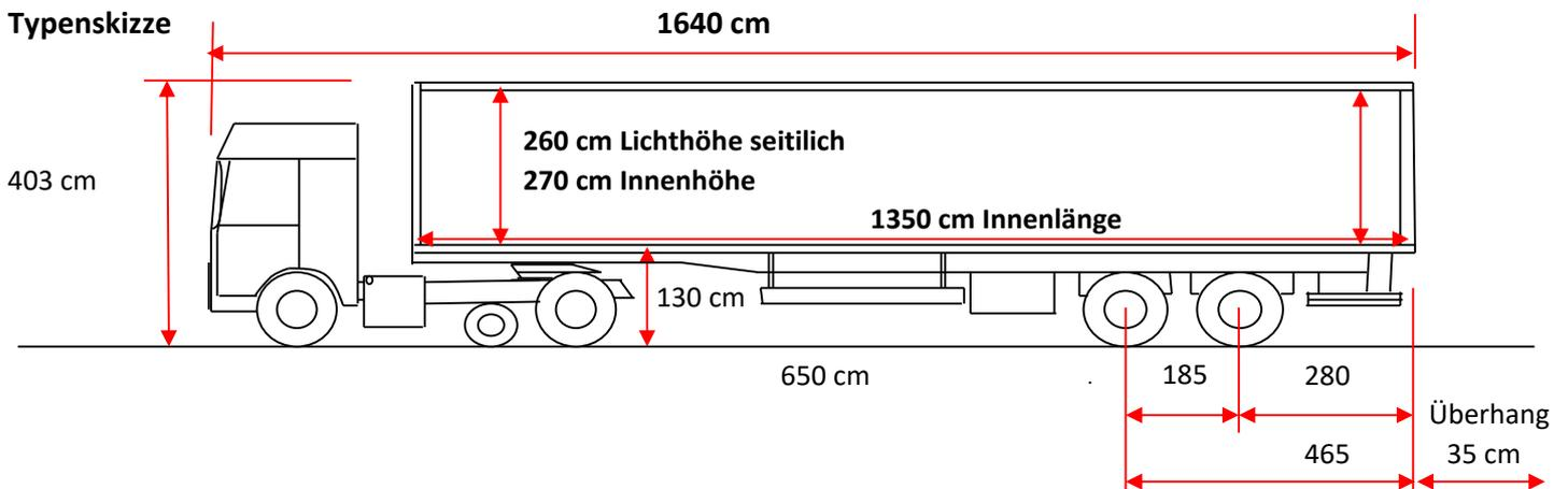
**Technik** Aufbau Sattelaufliieger XL-zertifiziert, Falthebebühne Tragkraft 1500kg
