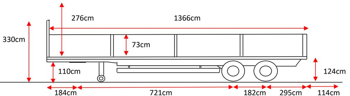
**Technik** Mit Seitenländen, Rungen, Überbreite, 1. Achse liftbar
